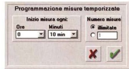
Il Sensor Pro consente la rilevazione multipla e temporizzata; in questo caso è possibile stabilire il numero di misure e la temporizzazione.
